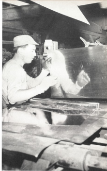
Lo spessore del materiale prodotto dalla linea della «Cornigliano» può variare da un minimo di 0,10 ad un massimo di 0,60 mm.
