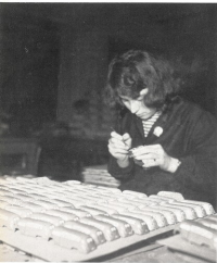
Il montaggio del giocattolo è un lavoro a catena vero e proprio. Un'automobilina media, lunga 13 cm, richiede ben 24 operazioni.
